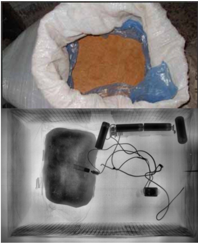
IED in een plastic krat met kneedspringstof, duidelijk te zien zijn de batterijen
