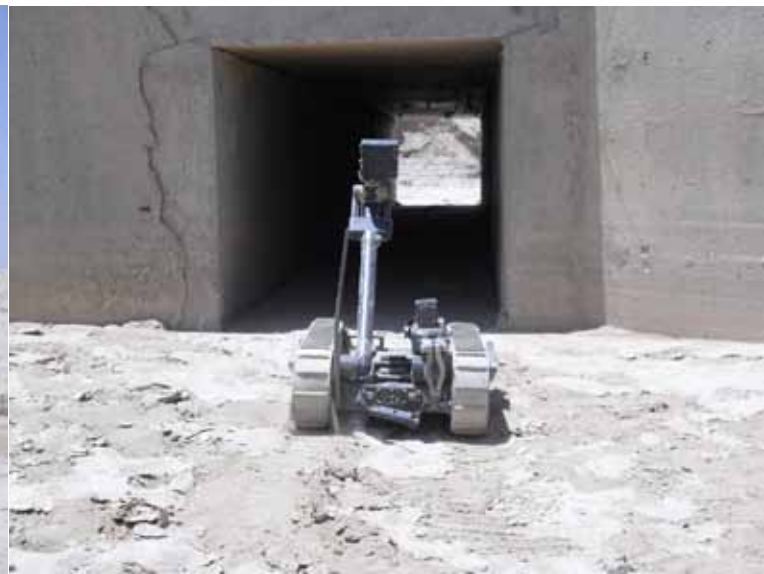
Met een Talon small mobile robot probeert de Amerikaanse bedienaar, die vanuit een van de MRAPs de robot bedient, onder de duiker waar te nemen om vast te stellen of er al dan niet IEDs zijn geplaatst.
