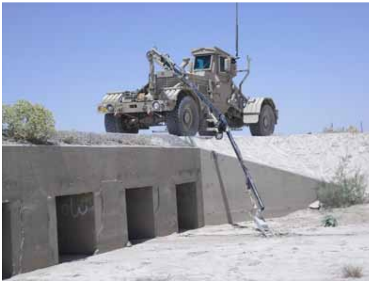
Een Amerikaanse Husky met interrogation arm probeert om onder de duiker waar te nemen met de camera. Conclusie was dat de camera op een andere wijze en op een andere positie gemonteerd moest gaan worden wilde men veilig onder de duiker kunnen waarnemen.
