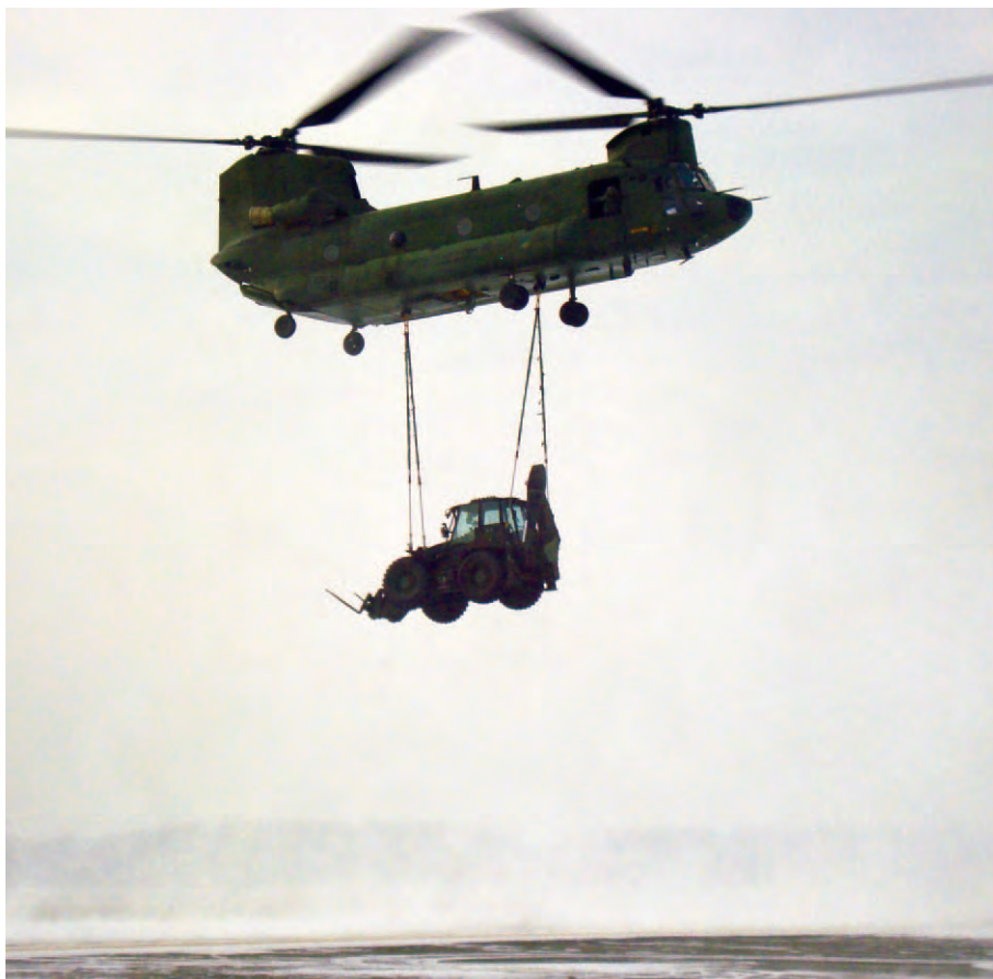
De graaflaadcombinatie is via heli en C-130 transporteerbaar. Ideaal voor een initial entry operatie.
