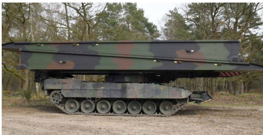
Zijaanzicht van de 'Lequaan' met een geplaatste 26 meter brug.
