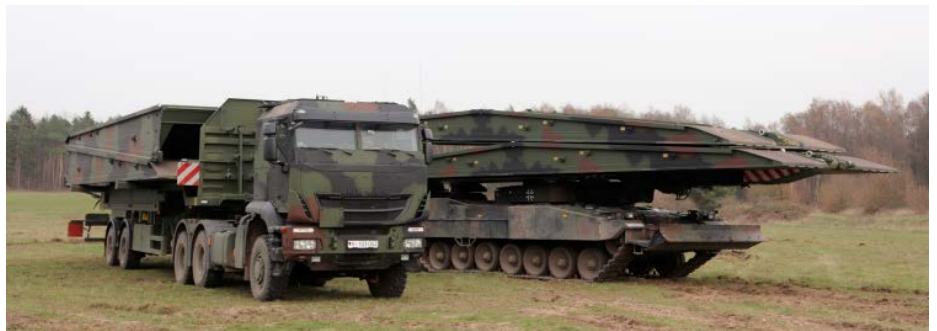
Het complete 'Duitse' bruglegsysteem Leguaan.
