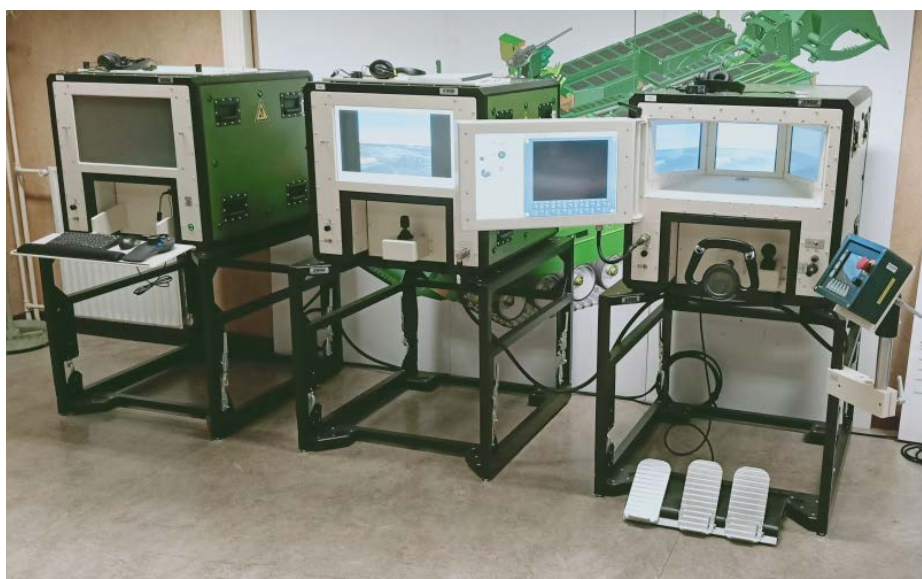
Een Table Top Trainer systeem bestaat uit; Links: IMI-TTT = module voor de instructeur, Midden: CMD-TTT = module voor de commandant, Rechts: DRV-TTT = module voor de bestuurder.
