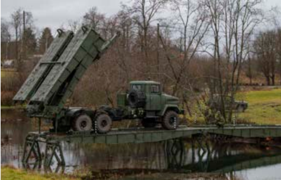
De TMM-3M brug
