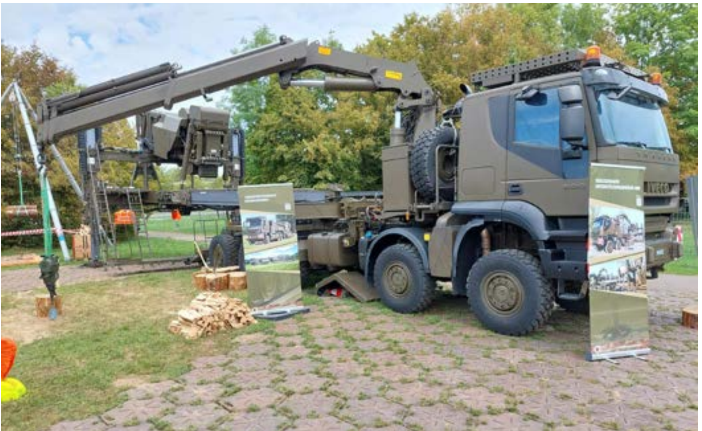
Het legstelsel van de Dry Support Bridge
